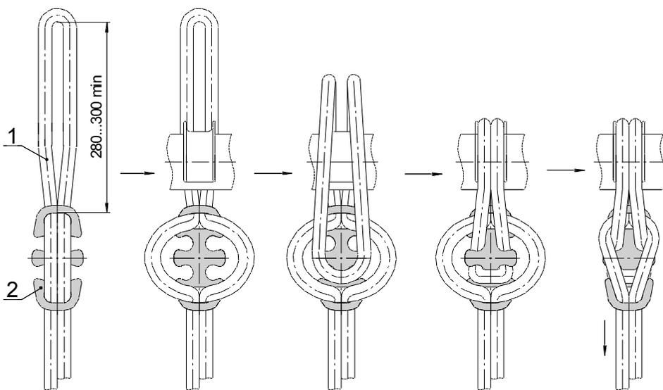
Рис.2. Схема безузловое крепления фиксатора на шнуре
