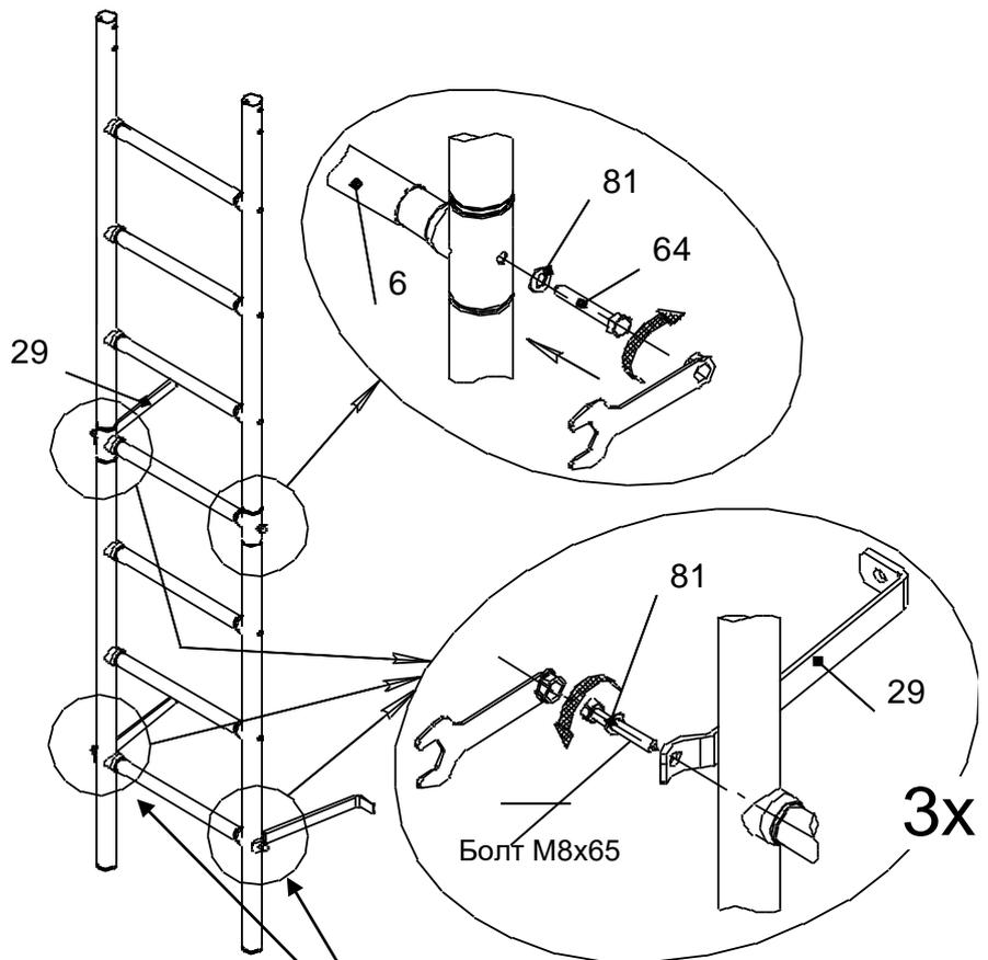
Открутить на нижней ступени болты M8x65, приставить кронштейны поз. 29. Закрепить ступень и кронштейны снятыми болтами с шайбами поз. 81.
