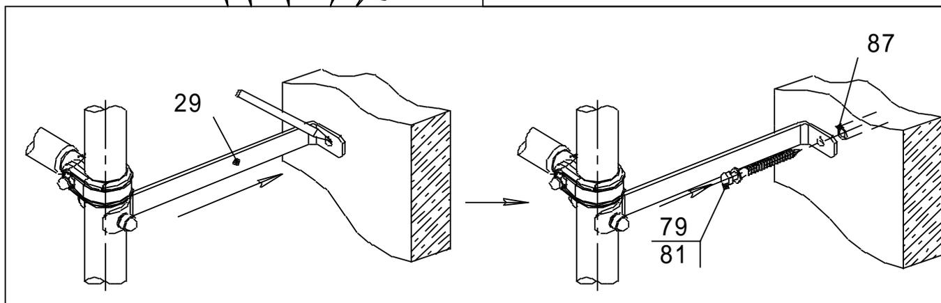
Гипсокартонные и тому подобные стены не пригодны для установки пристенного КОМПЛЕКСА. Прилагаемые к комплексу крепежные средства предназначены для бетонных и кирпичных стен. Используйте крепежные средства, подходящие для материала стен в вашем доме. Для выбора подходящих крепежных средств обратитесь в специализированный магазин.
