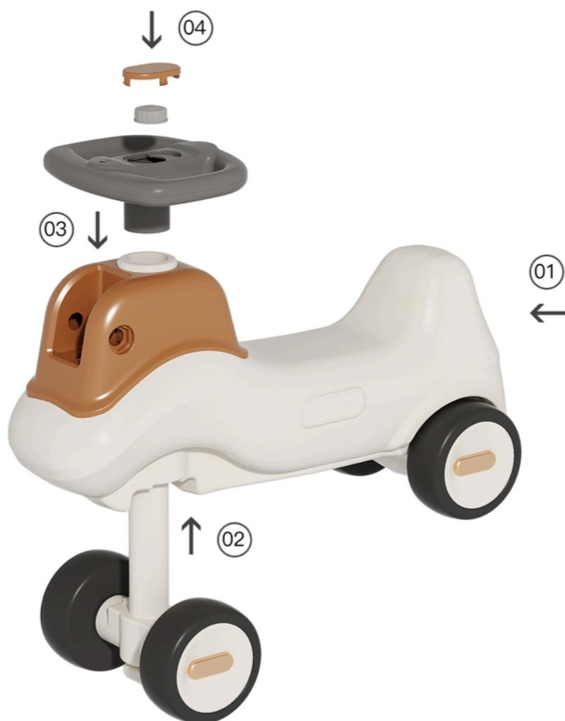
Шаг 1. Закрепите переднее колесо и рулевой рычаг к основному корпусу, затем закрепите сам руль с помощью шестигранной гайки и заглушки.
